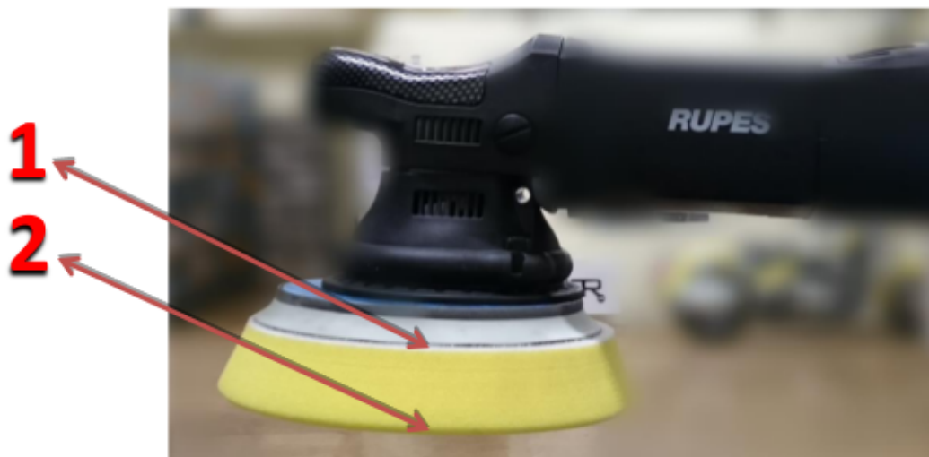
Friktionsvärme skapas i zon 1 och 2
